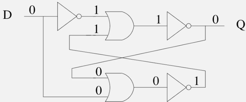
Figuren viser et forsøk på å lage en D-vippe som skal kunne brukes til å lagre ett bit i et register. Hva er problemet som gjør at denne konstruksjonen må utvides noe for å få en velfungerende D-vippe?
